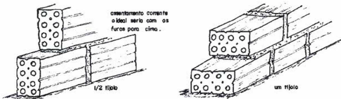
Figura 1 - Execução de alvenaria utilizando tijolos furados.
