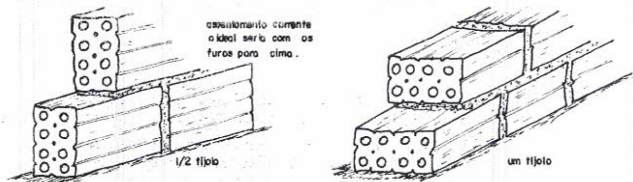
Figura 1 - Execução de alvenaria utilizando tijolos furados.
