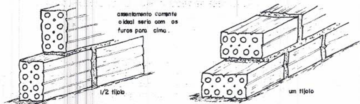
Figura 1 - Execução de alvenaria utilizando tijolos furados.
