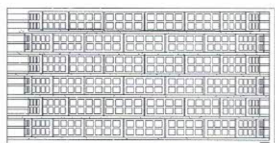
DETALHE: ALVENARIA SUMIDOURO Esc.: 1:50
