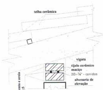
Detalhe de apoio vigota sobre alvenaria, s/escala
