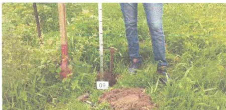
Foto 13 – Detalhe de Sondagem S 09 com Solo Aluvionar em 453.236 / 9.358.391.
