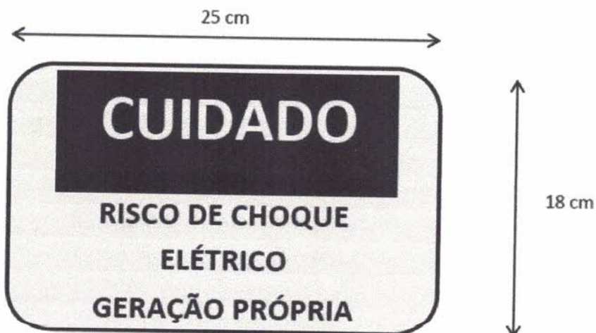
Figura 03 – Placa de advertência e sinalização de Geração Própria.
