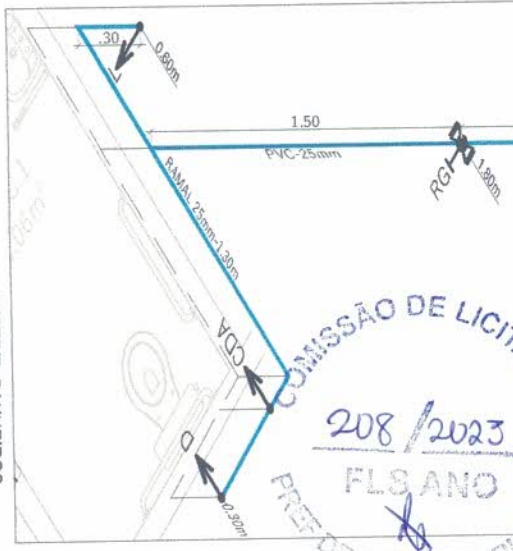
DISTRIB. BANHEIROS ISOMÉTRICO esc: 1:25
